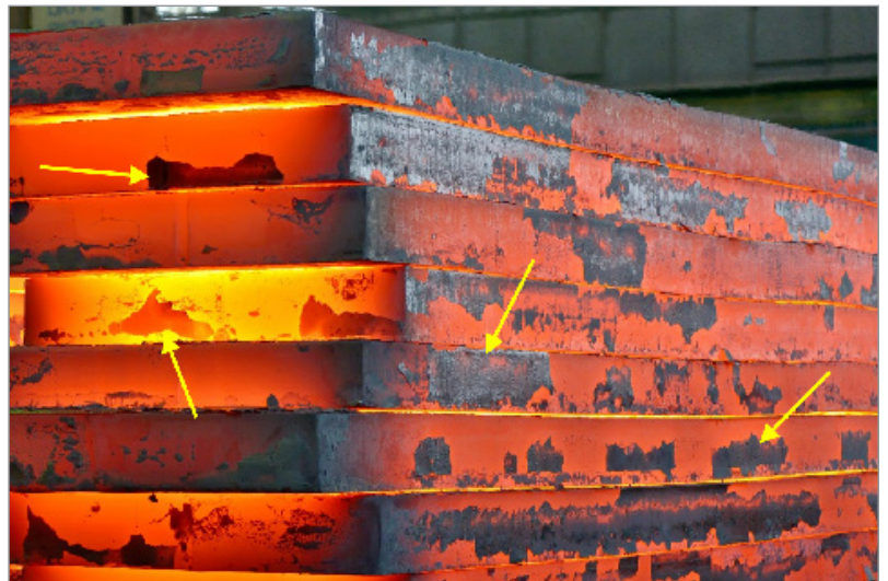
Figuur 4.0 - Stalen platen enkele minuten na het produceren. De pijlen tonen de walshuid (ijzeroxiden) geproduceerd door chemische corrosie. Dit is een natuurlijk proces waarbij het "niet-natuurlijke" materiaal (staal) weer wordt omgezet in een mineraal.
